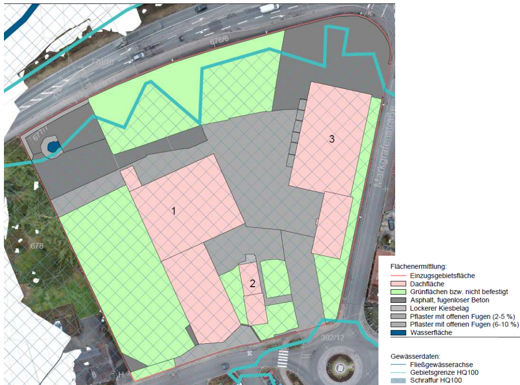
Abbildung 2 : IST-Zustand - Aktuelle Bebauungsverhältnisse
